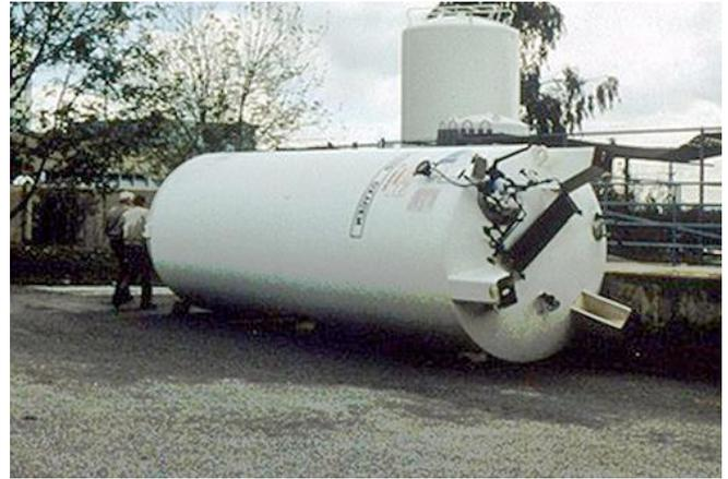
Abb. 2.17.1 und 2.17.2 > Trägheitsversagen bei Tankwänden
