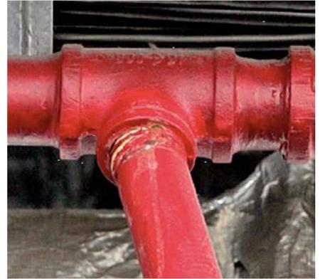
Abb. 2.18.3 > Schaden bei Verzweigung
